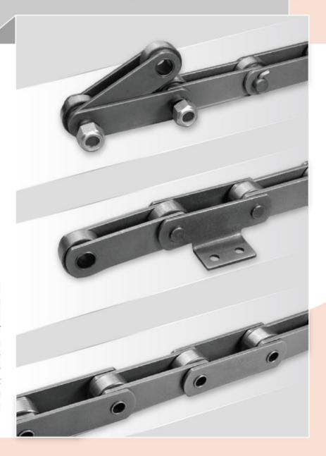
棕榈油链条具有较高的强度,输送平稳,良好的防腐蚀、耐磨损等性能。棕榈油链条需要链板材料密度高,且热处理要做到保温时间长,所以我们采用加强型链板优化设计,其他零件表面硬化处理,并上特殊润滑脂, 使得链条强度高、耐磨性能好。
