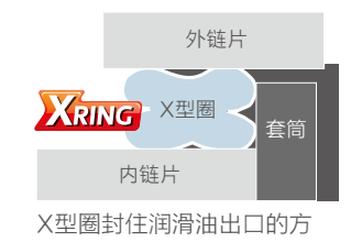
X型圈封住润滑油出口的方式
