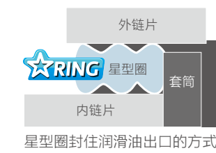
星型圈封住润滑油出口的方式
