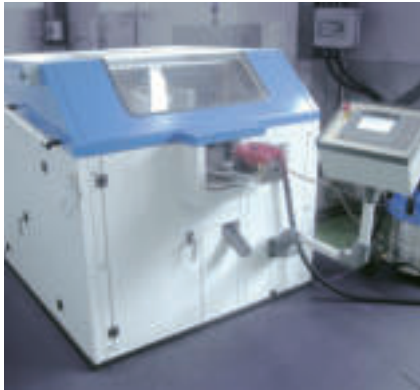
德国高精度卷管机 High Precision Rolling Machine from Germany 设备亮点： 套筒卷制同时可以进行油孔制作 Bush rolling can be done at the same time with hole making 设备精度： 保证套筒外径公差 \leq 0.02\text{mm} ， 接缝 \leq 0.02\text{mm} Ensure tolerance of outer diameter \leq 0.02\text{mm} seams \leq 0.02\text{mm} 设备速度： 400 次 / 分钟 Equipment speed: 400 times/minute
