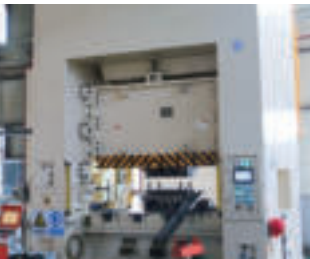
500吨冲床 500 Ton Punch 设备作用： 链板冲压成型 Chain plate stamping 设备亮点： 冲压力大，精度高 Large impulse pressure and high precision
