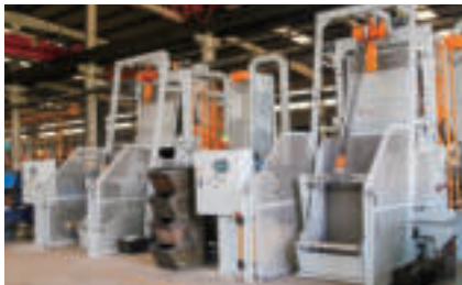
500吨冲床 500 Ton Punch 设备作用： 链板冲压成型 Chain plate stamping 设备亮点： 冲压力大，精度高 Large impulse pressure and high precision
