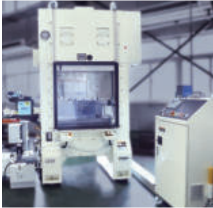
日本精密冲床 Precision Punching Machine From Japan 设备精度： 送料精度 \pm 0.05\text{mm} 真直度： 25\text{ }\mu\text{m} 平行度： 33\text{ }\mu\text{m} 直角度： 9\text{ }\mu\text{m} 保证链板冲裁节距公差 \leq 0.005\text{mm} Feeding accuracy \pm 0.05\text{mm} Straight degree: 25\text{ }\mu\text{m} parallelism: 33\text{ }\mu\text{m} Straight Angle: 9\text{ }\mu\text{m} Guarantee blanking pitch tolerance of chain plate \leq 0.005\text{mm} 设备速度： 500 次 / 分钟 Equipment speed: 500 times/minute
