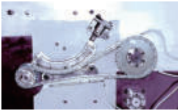
综合性能试验台 Comprehensive Performance Test Platform 设备作用： 检测链条耐磨性能 Test chain wear resistance
