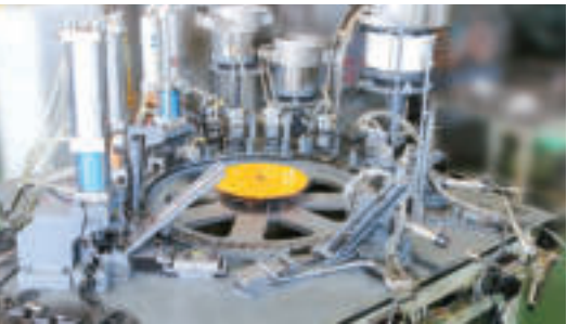
密封圈链条组装平台 Sealing Ring Chain Assembly Platform 设备作用： 组装密封圈链条 Assemble sealing ring chain
