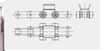
\* 输送链 \* 适用于汽车烘干流水线
