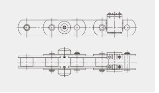
\* 输送链 \* 适用于汽车精饰工艺线
