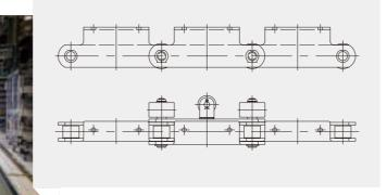
\* 输送链 \* 适用于汽车总装线
