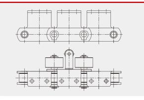
\* 输送链 \* 适用于汽车车架焊接生产线
