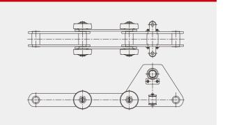
\* 输送链 \* 适用于汽车前处理及电泳作业线
